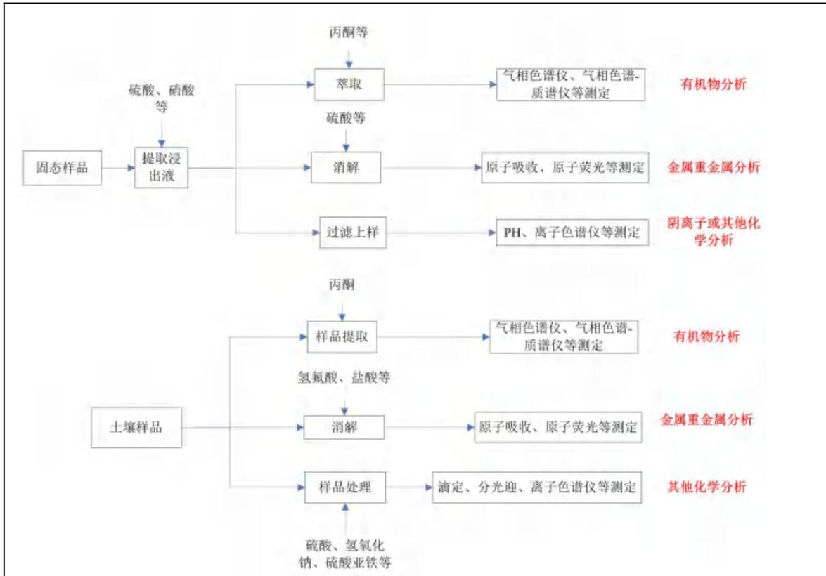
图 2-5 固态/土壤样品检测工艺流程
